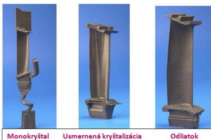
Obr. 5 – Možnosti technológie výroby lopatiek [4].
